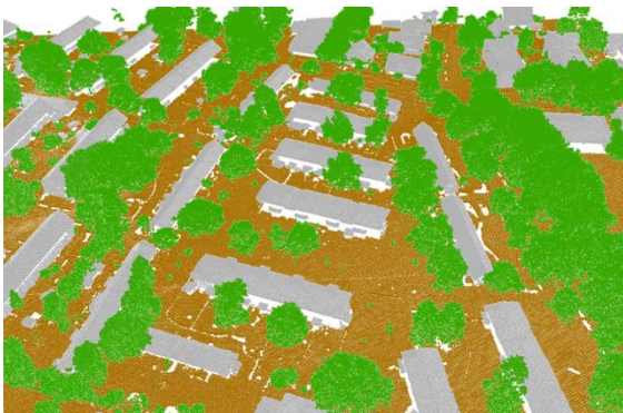
Abbildung 1: Hochaufgelöste Laserscan-Punktwolke (links) und daraus generierte Dachflächen (rechts)
